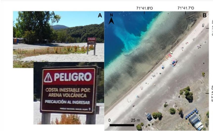
A) Cartelería instalada por Parques Nacionales en un delta que creció significativamente por deposición de la tefra de CC2011. B) Imagen dron del deslizamiento subacuático ocurrido en marzo 2021 en el balneario del camping diurno del lago Espejo. El fenómeno movilizó material piroclástico de la erupción del Cordón Caulle 2011 depositado sobre las pendientes del veril.
