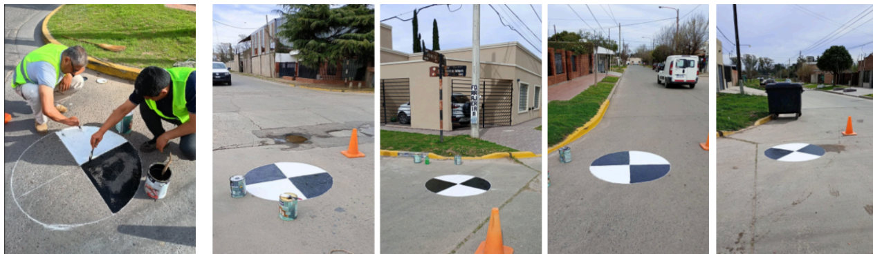
Marcas de los puntos de apoyo. Medición con GPS geodésico.
