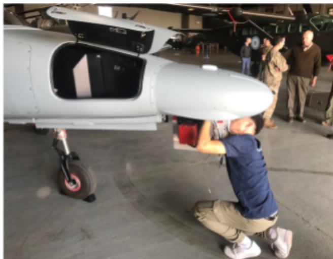
Instalación del sensor Lidar en la “nariz” de la aeronave
