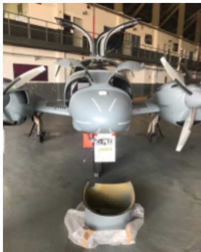
Instalación del sensor Lidar en la “nariz” de la aeronave
