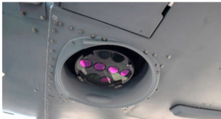
Instalación de la cámara fotogramétrica en el fuselaje de la aeronave
