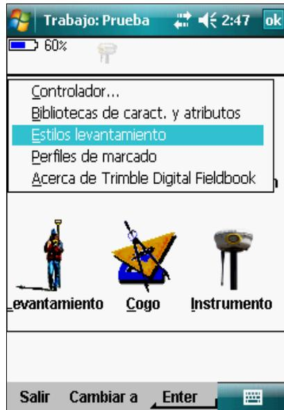
3. Crear un nuevo **Estilo de levantamiento** de tipo **GNSS**, asignarle el nombre **NTRIP** y configurar **Opciones móvil** y **Radio móvil** del siguiente modo:
